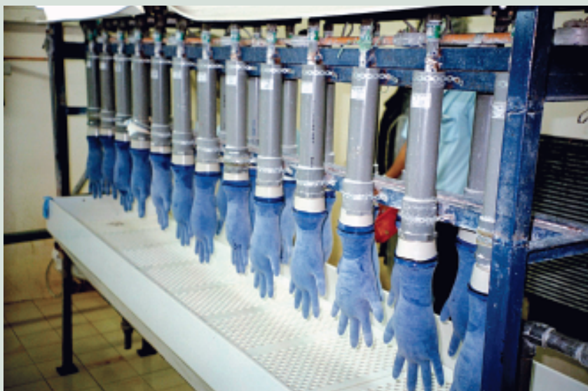
Fig. 1. Tæthedstest. Med regelmæssige intervaller udtages en portion handsker fra produktionslinjen og testes for vandtæthed: Efter opspænding i prøvestander fyldes der én liter vand i hver. Efter 2-3 min. kontrolleres om der siver vand ud fra huller i handskerne.
