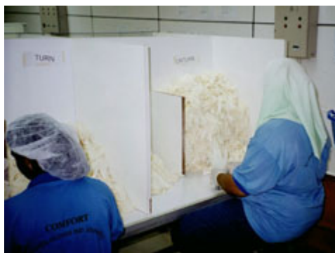
Fig. 4. Handskerne vendes manuelt når de er blevet vasket og overfladebehandlet på ydersiden. Når de er vasket og overfladebehandlet på indersiden, vendes de tilbage igen.
