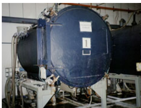
Fig. 3. Vasketromle til efterbehandling af handsker. I maskinen kan handskerne vaskes og overfladebehandles med enten klor eller med silikoneolie.
